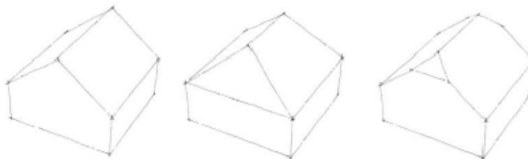
Dans les localités de Hobscheid et Eischen, les toitures à versants ont une pente de minimum vingt-cinq degrés (25°) et de maximum quarante degrés (40°). Dans les localités de Septfontaines, Roodt, Simmerschmelz et Greisch, elles ont une pente de minimum vingt degrés (20°) et de maximum quarante degré (40°).
